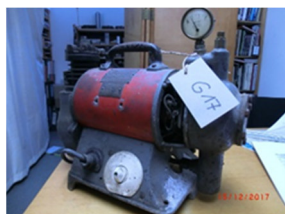
Luftpumpe mit Kompressor, Handgriff, Manometer, Schalter und elektrischem Anschlusskabel, aus der früheren Werft Lindau; Vorderseite 2 Metallschilder Heinrich Leo Gera und AEG 1905; Rückseite 2 Metallschilder mit Bedienungsanleitungen, leicht beschädigt, ca. 25 kg
