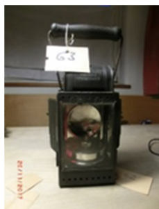
metallene Karbid-Rangierlampe DR; mit aufklappbaren Holzhandgriff und Seitenwänden; Aufschrift J.C.Giessing, Nürnberg, Kohlegasse 6-12; ca. 1930er Jahre?
