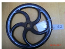
gusseisernes Handrad vom Wasserkran Bw Lindau Insel, ca. 1930 Jahre ?; ca. 10 kg
