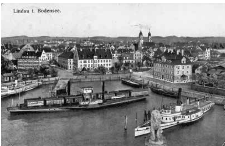
„Dampftrajekt II“ im Lindauer Hafen, vermutl. um 1910 Dampftrajekt II war mit zwei unabhängig voneinander steuerbaren Dampfmaschinen ausgestattet, die über eine Achswelle jeweils ein Schaufelrad antrieben. Aufgrund seiner Länge benötigte Dampftrajekt II das gesamte Lindauer Hafenbecken zum Manövrieren. (Postkarte Sammlung Fügen)
